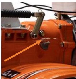
Verificarea nivelului de ulei al transmisiei
